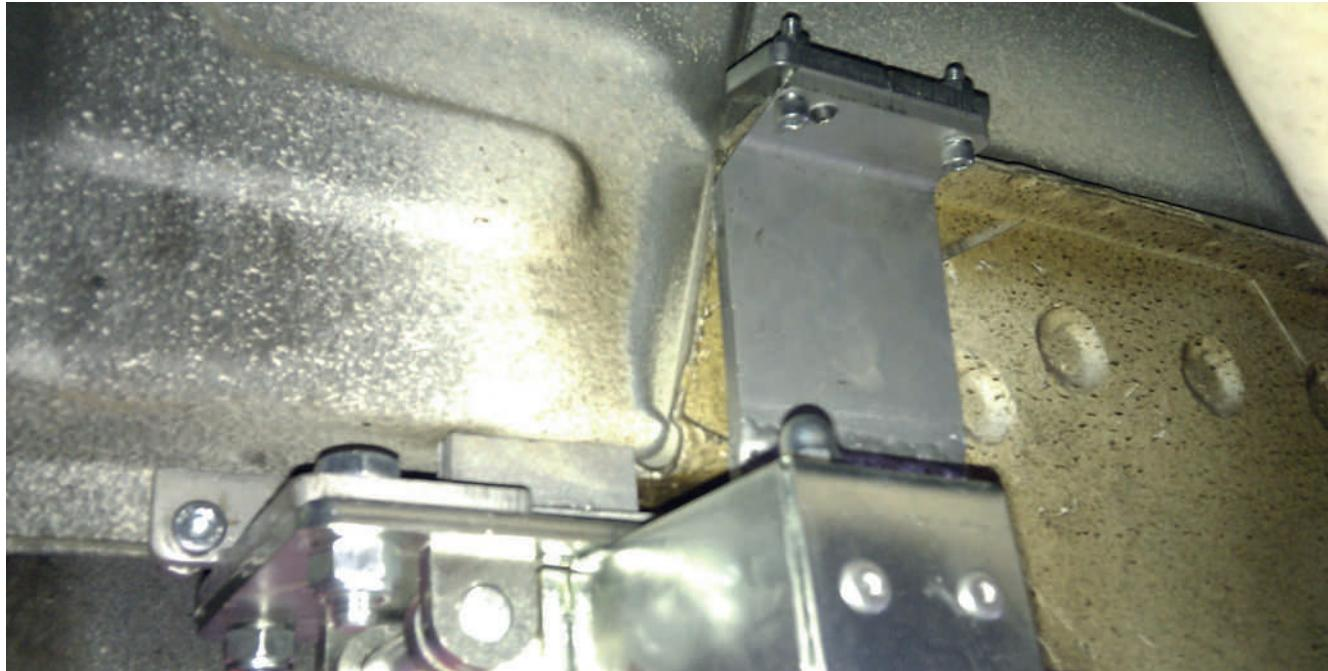
Bringen Sie den Adapter so weit wie möglich nach vorne. Entfernen Sie ggf. das Dichtungsmaterial, um eine bessere Haftung zu erreichen. Benutzen Sie einen Wagenheber, um die Halterung in der richtigen Position zu fixieren und bohren Sie ein seitliches Loch von 8 mm, dann befestigen Sie es mit einer Schraube.
