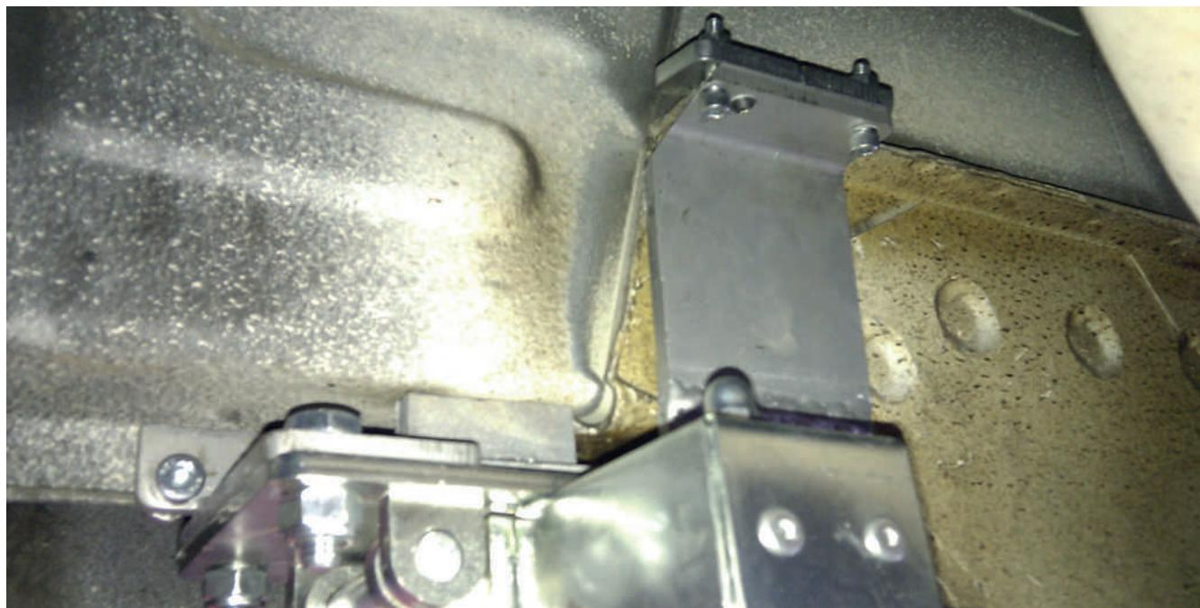
Sätt adaptern så långt fram som möjligt. Om det behövs, ta bort eventuellt tätningsmaterial för att få en bättre vidhäftning. Använd en flaskstuds för att fixera fästet i rätt läge och gör ett 8 mm sidohål, fäst sedan med en skruv.
