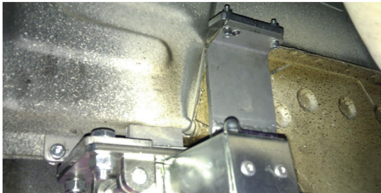
Sæt adapteren så langt frem som muligt. Fjern om nødvendigt tætningsmateriale for at opnå bedre fastholdelse. Brug en flaskevogn til at fastgøre beslaget i den korrekte position og lav et 8 mm sidehul, og fastgør det derefter med en bolt.
