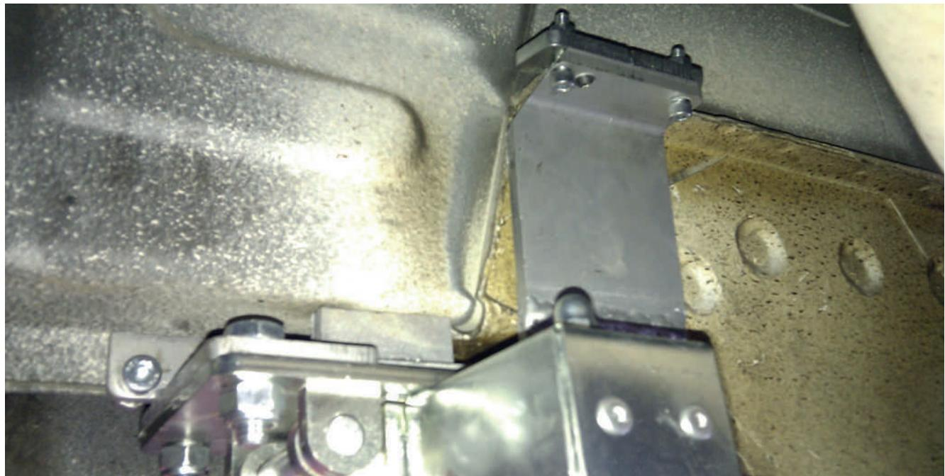
Aseta sovitin mahdollisimman pitkälle eteen. Poista tarvittaessa tiivistemateriaali, jotta kiinnityminen paranee. Kiinnitä kiinnike oikeaan asentoon pullotunkilla ja tee 8 mm:n sivureikä ja kiinnitä sitten pultilla.
