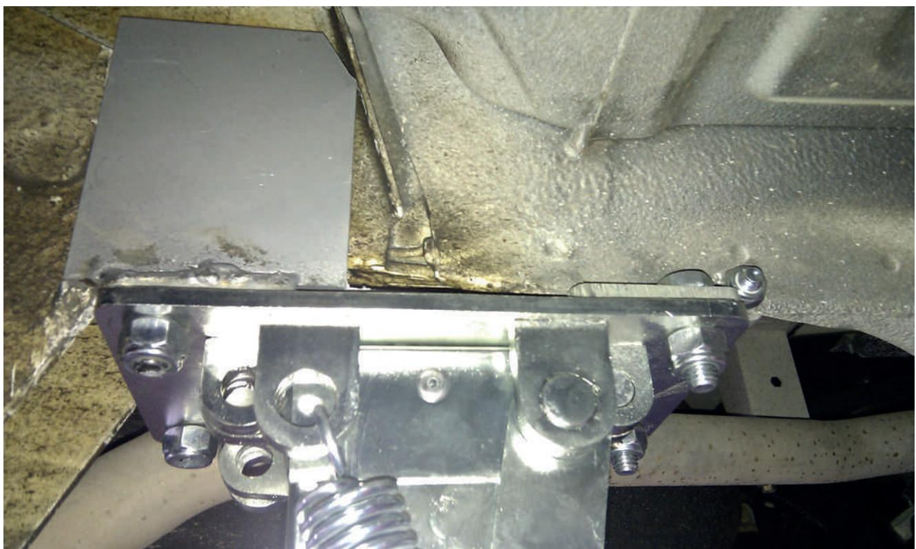
El gato del motor debe estar orientado hacia el exterior del vehículo y la rotación hacia la parte delantera.
