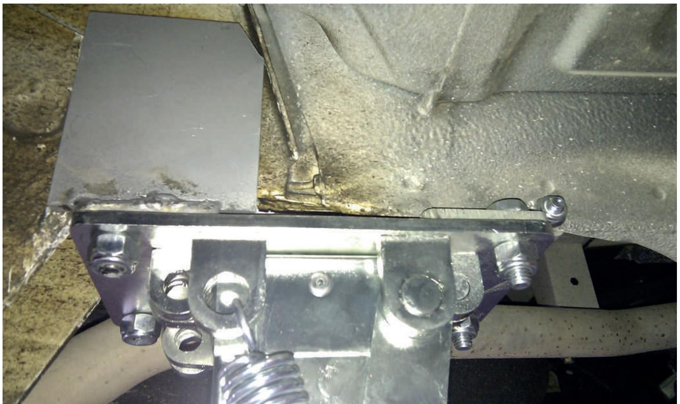
Die Motorbuchse muss zur Außenseite des Fahrzeugs zeigen und nach vorne gedreht werden.
